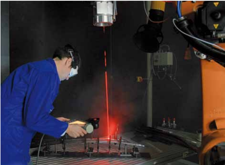
Abbildung 1: Laserstrahlung trifft im Fokus auf passive Schutzwand (Laserstrahlquelle: Faserlaser mit 8 kW, Spotdurchmesser: 800 µm, Abstand: 1000 mm, Schutzwandmaterial: Stahlbeton mit 16 cm Dicke)
