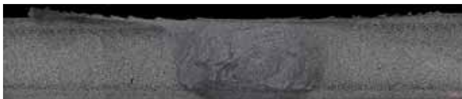
Abb. 1: Querschnitt durch eine typische Rührreißschweißnaht
