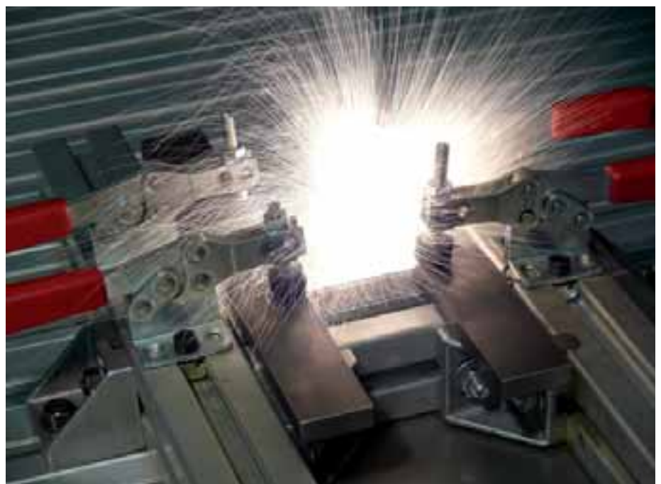
Abb. 1: Materialtrieb beim Remote-Laserstrahl-Abtragsschneiden mit Single-Mode-Laserstrahlung
