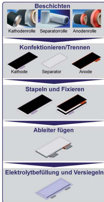
Abb. 1: Prozesskette bei der Fertigung von Lithium-Ionen-Zellen
