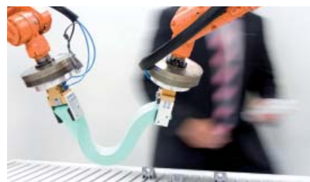
Innovation trifft Leistung: Handhabung formflexibler Bauteile mit kraftgeregelten kooperierenden Industrierobotern
