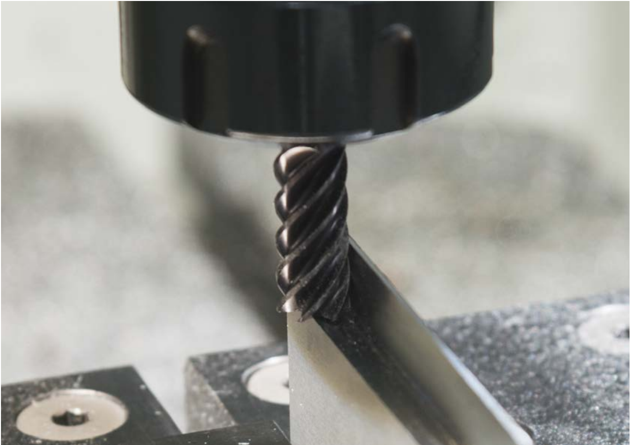
Fräsbearbeitung eines dünnwandigen Aluminiumbauteils
