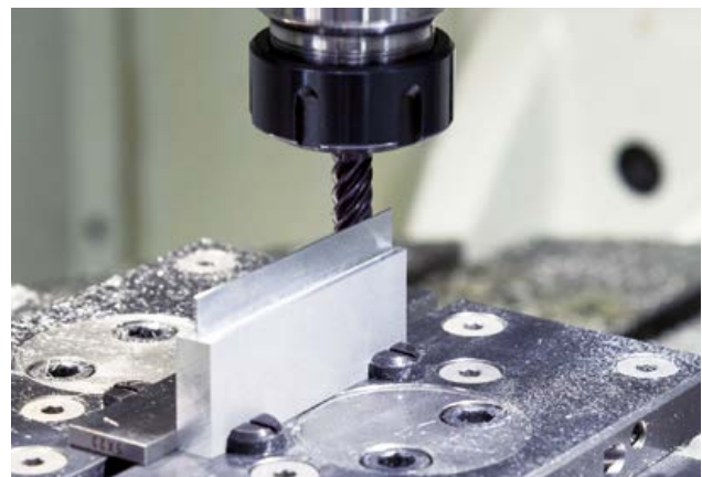
Schichtbearbeitung eines dünnwandigen Steges
