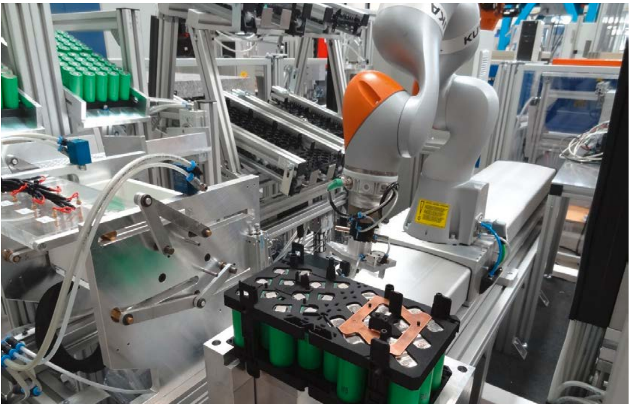
Versuchszelle zur Modulmontage am iwb
