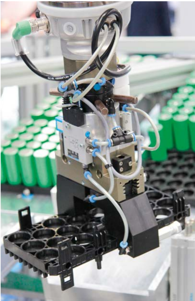
Kombinierter Backen-Sauggreifer zur Handhabung der Zellhalter
