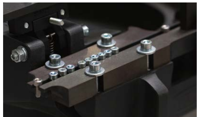
Detailansicht der Ordnungsstrecke eines Vibrationswendelförderers
