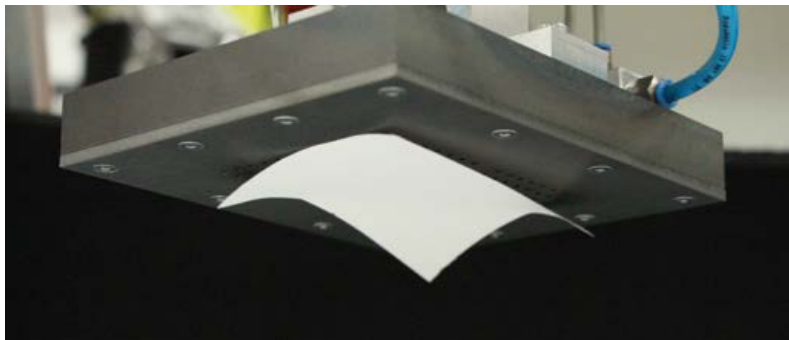
Abblendeverhalten eines Separators unter Elektrostatikeinfluss
