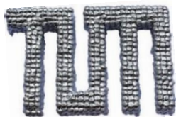
Abbildung 1: Mittels MJT additiv gefertigtes Logo der TUM aus AlSi12. Die Höhe beträgt ca. 2 cm
